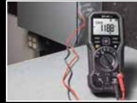
Enregistrement automatique des données en vue de trouver les erreurs intermittentes
