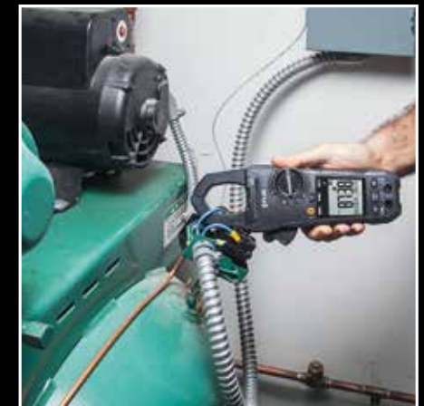
Inrush Current détecte les pics de tension au démarrage
