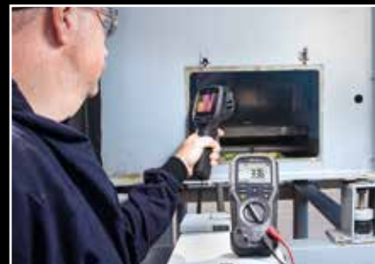
Utilisez MeterLink pour ajouter des mesures électriques aux images IR des caméras FLIR
