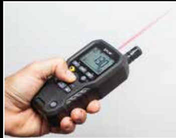
Le thermomètre IR laser relève rapidement les températures de surface
