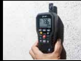
Mesurer l'humidité jusqu'à 1,9 cm sous la surface
